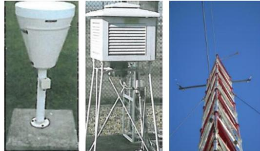
Exemples d'équipements pour les mesures de pluviométrie, température et vent ©EDF
